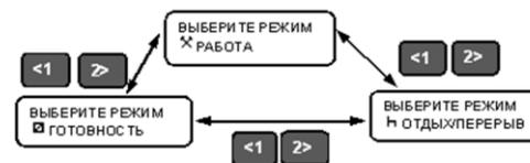
При движении ТС вид деятельности «управление» (☑) выбирается автоматически для водителя, «готовность» - для второго водителя.
